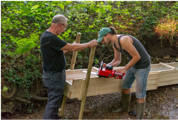
Abb. 18: Aufstellen der Waschrinne im Tobelbach (© F. Stremke).
