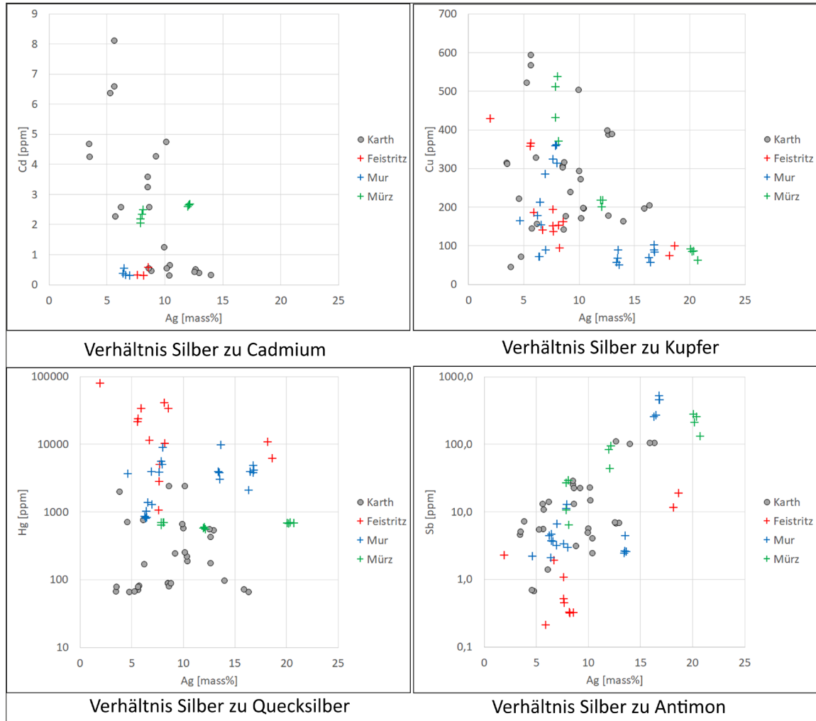
Abb. 3: LA-ICP-MS Daten des Goldes aus dem Karth sowie aus den Vergleichsflüssen Feistritz, Mur und Mürz. Die geringsten Unterschiede bestehen zwischen den Goldpartikeln aus dem Karth und jenen aus der Mürz (© S. Elmer).
